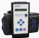
PMA-2100 是一款科研级数据记录辐射计，它可以通过超过35种不同探测器的搭配来对UVA、UVB、UVC、Visible，以及IR光进行测量。
